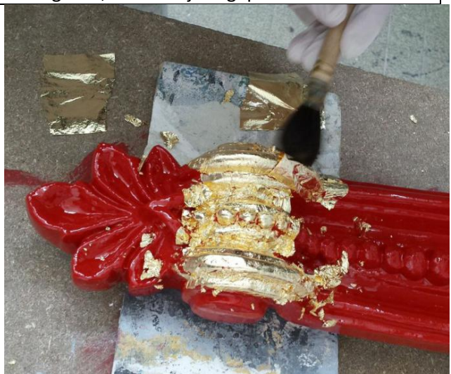
Foto 19, Leg het volgende blaadje op de ondergrond, iets over je al geplakte deel
