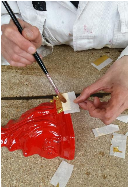
Foto 13, Leg een volgende stukje goud iets over het andere heen
