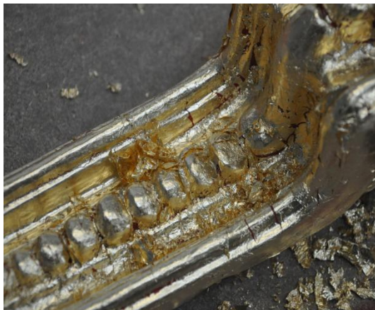
Foto 26, Kijk of alle losse delen verwijderd zijn
