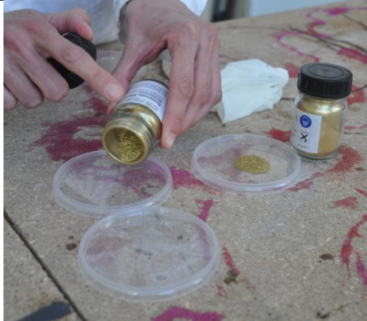
Foto 16, Bronspoeder in een hoopje op het deksel leggen
