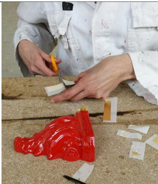
Foto 9, Knip het bladgoud in kleine strookjes
