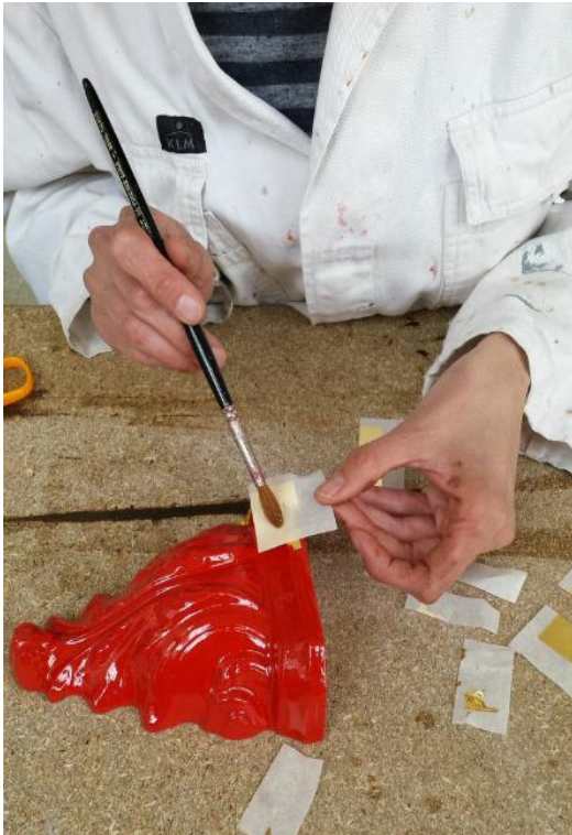
Foto 13, Leg een volgende stukje goud iets over het andere heen
