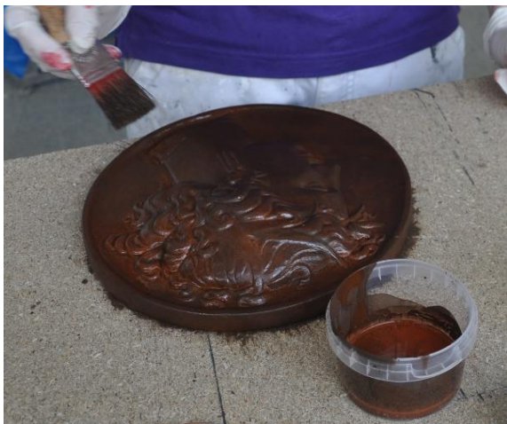
Foto 16, Tamponeer de schellak met pigmenten over de ondergrond
