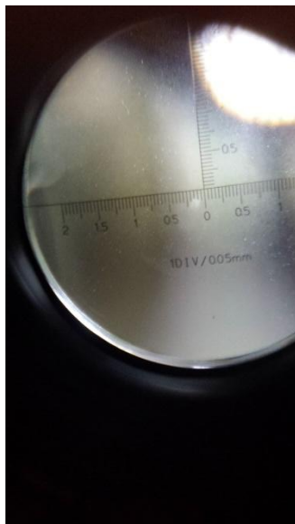
Figuur 81, Meten van de gaatjes van de houtworm
